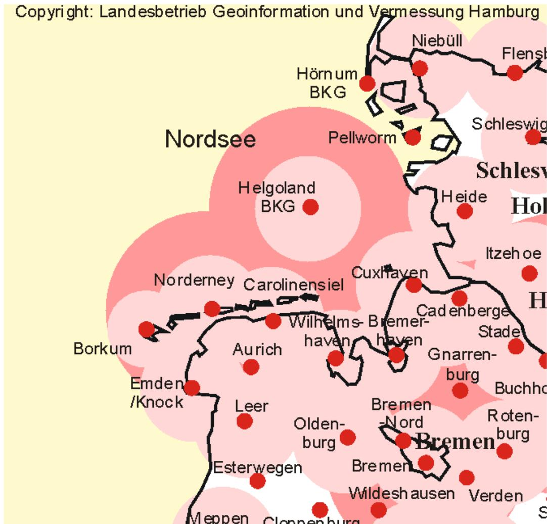
**Fig. 8:** Positions of reference stations of the "Satellitenpositionierungsdienst"
